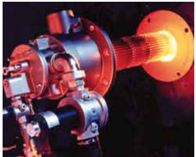
Flammenlose Oxidation: Der Stickstoffoxidausstoß wird durch Vorheizen der Luft im Brenner verringert. In der Fertigungs- und Verfahrenstechnik werden Methoden für die Industrie entwickelt, weniger Energie einsetzen zu müssen. Die Bundesregierung unterstützt das Bestreben, die Ressourceneffizienz zu verbessern.
